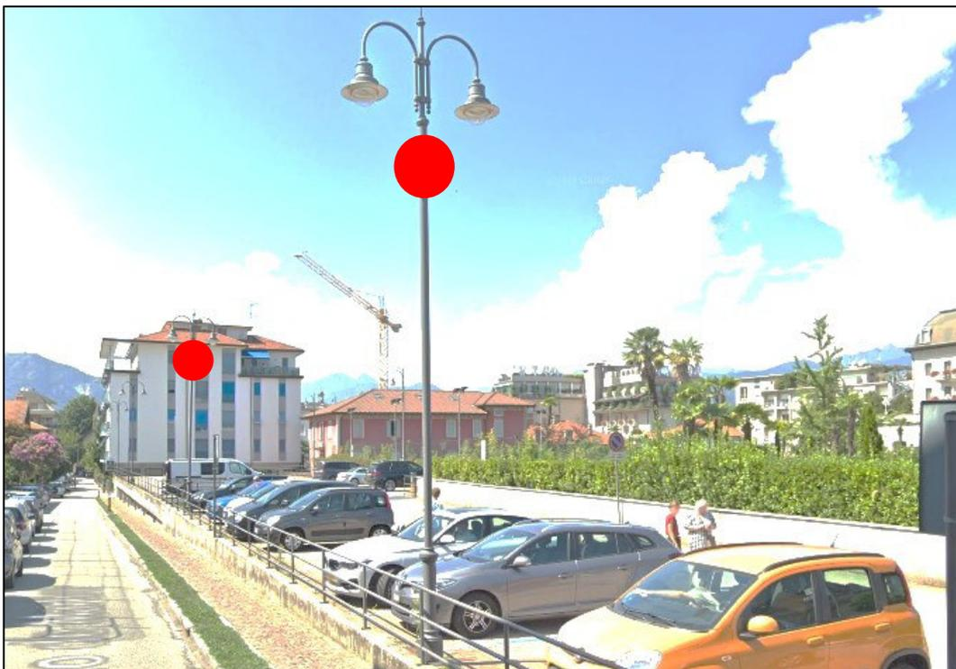
**28, 29 - PARCHEGGIO VIA GILBERTO BORROMEIO** – 4 TELECAMERE IN PROGETTO – si tratta di 2 postazioni a doppia telecamera per il controllo della parte centrale e terminale del parcheggio di via Gilberto Borromeo. I segnali sono raccolti da QN10 ed inoltrati al sistema centralizzato di controllo e visualizzazione sul tracciato QN10 – QE5 – QE3 - ponte radio QE3 – Municipio – Vigili Urbani.
