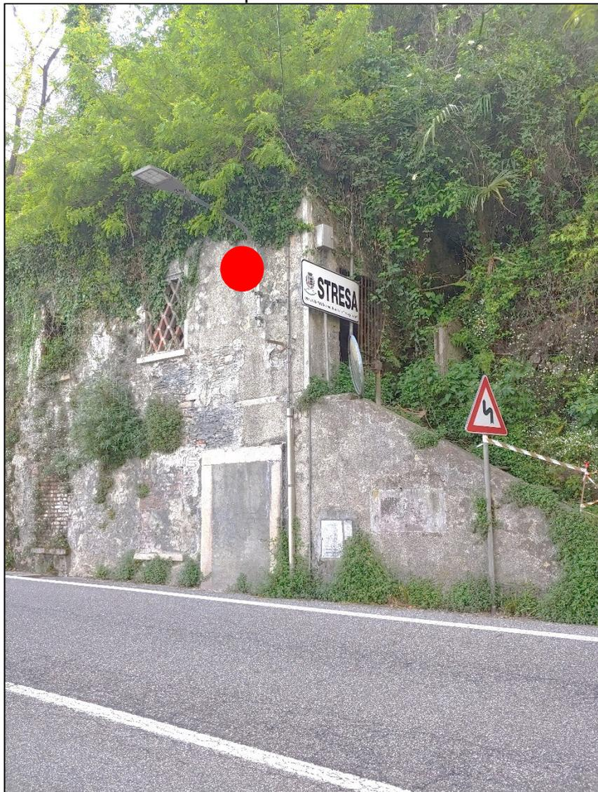
La postazione 10 – SS33 – ingresso del Vignolo Park - sarà realizzata installando un nuovo sostegno a palo con un pannello fotovoltaico per la produzione di energia elettrica. La posizione è troppo lontana da zone servite da ENEL e risulta antieconomico realizzare un nuovo POD.
