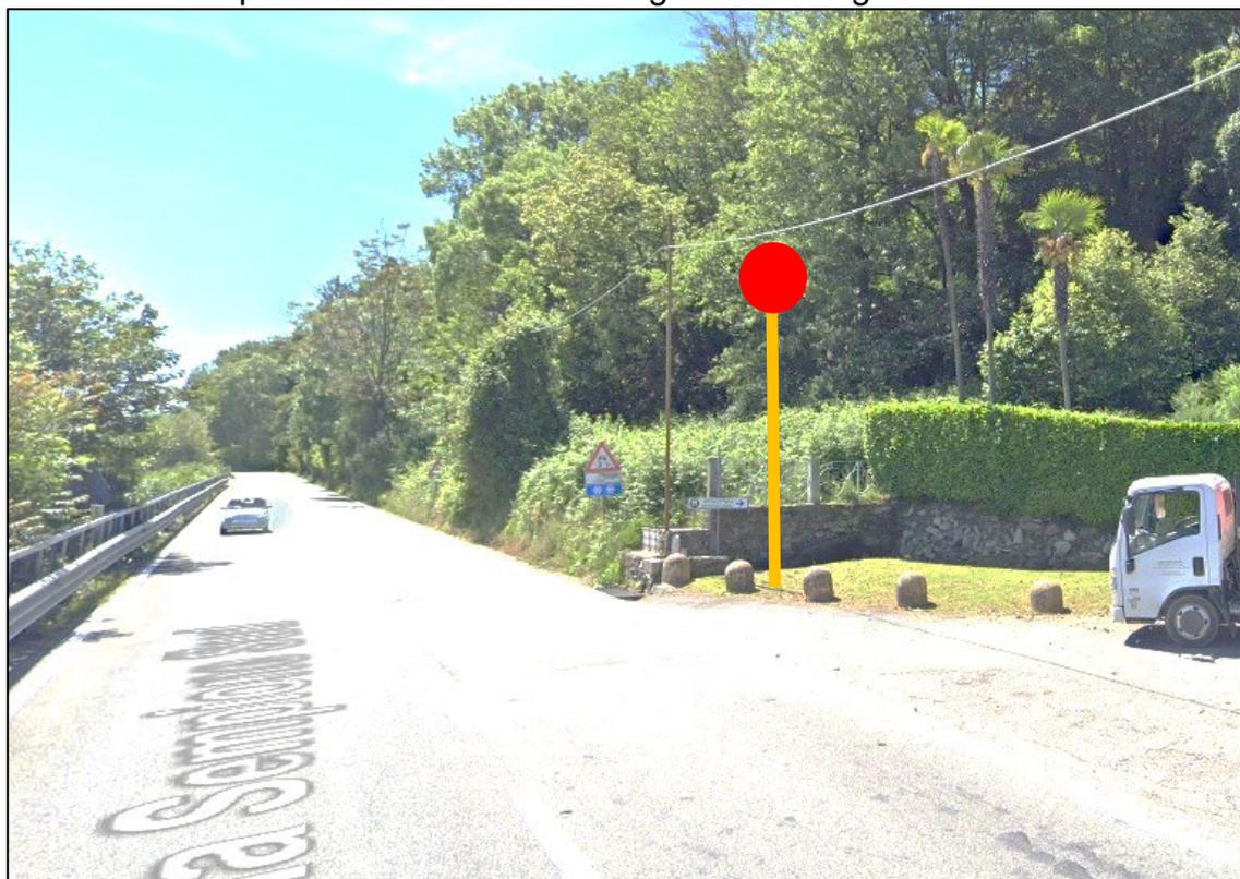
La postazione 11 – SP Baveno Levo – presso il lavatoio di Levo - sarà realizzata installando un nuovo sostegno a palo a fianco del lavatoio comunale. Verrà effettuato un nuovo allacciamento per energia elettrica (nuovo POD), con box contatore e il nuovo quadro elettrico QN3 di alimentazione, posizionati a terra a ridosso della parete del lavatoio. QN3 conterrà l'elettronica di collegamento della telecamera (switch dati + router). La trasmissione dati sarà con SIM 4G.
