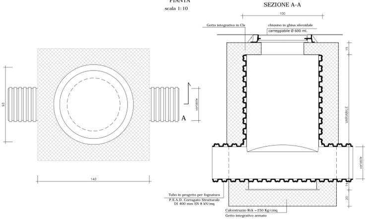
Tubo in progetto per fognatura P.E.A.D. Corrugato Strutturale DI 400 mm SN 8 N/mq
